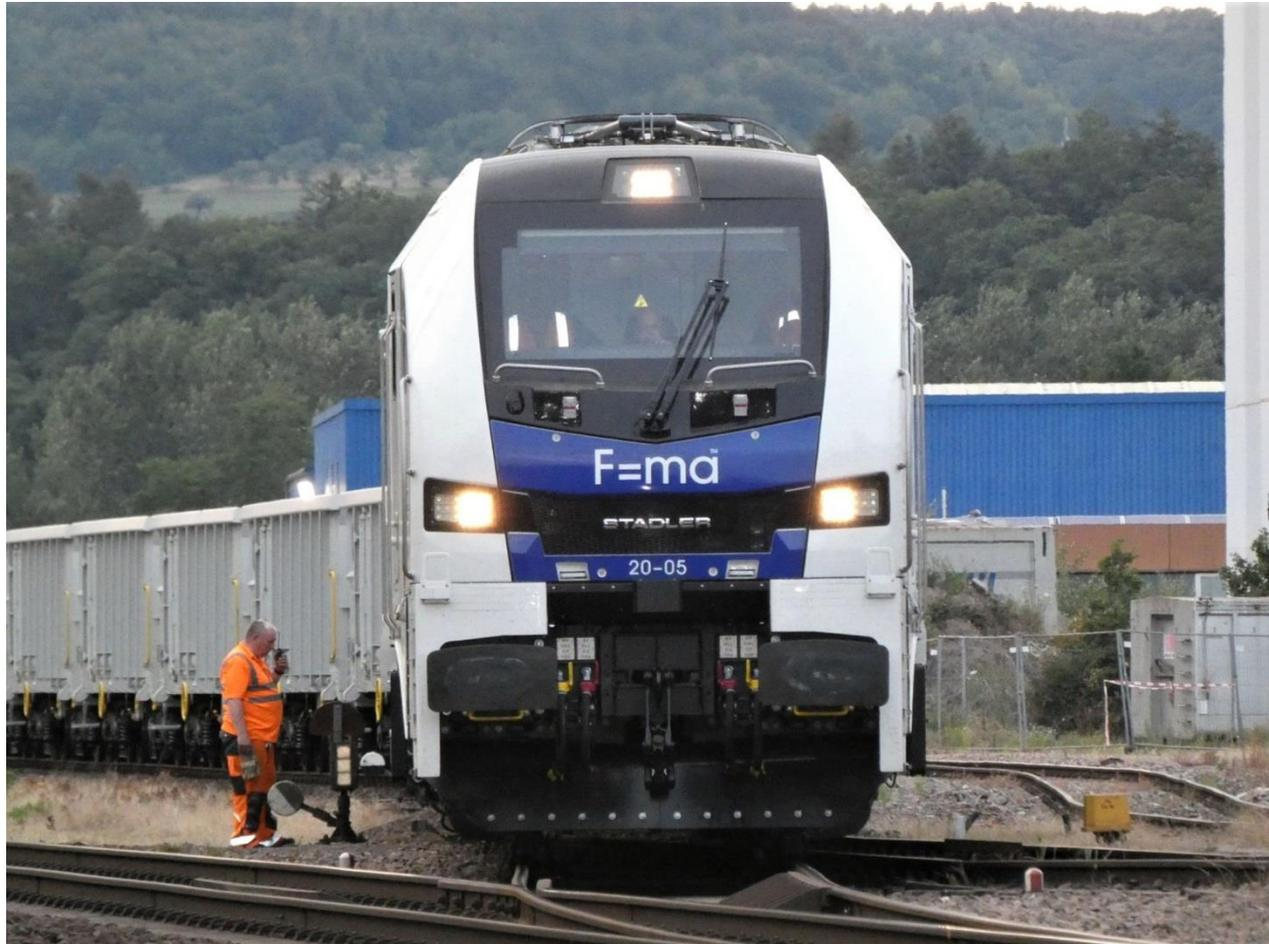
Sie kann mit den Stromsystemen 25 kV 50 Hz // 15 kV 16,7 Hz  $\simeq$  und 1,5 kV  $\equiv$  ausgerüstet werden. Der Dieselmotor kann im Gleichstromnetz zusätzlich noch als Booster verwendet werden. Diese Lokomotive wurde vor ihrem Einsatz in Frankreich, Belgien und Rumänien intensiven Erprobungen unterzogen.
