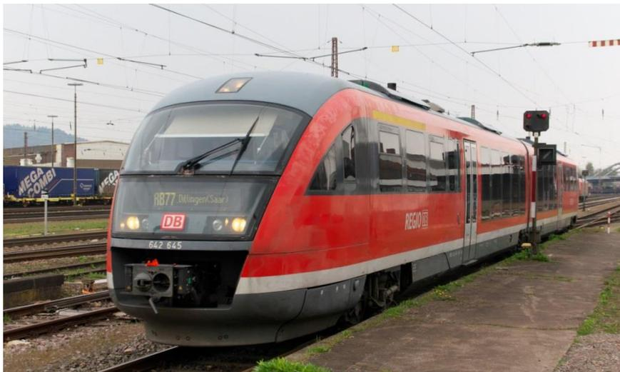
**Dieseltriebwagen der Baureihe 642
