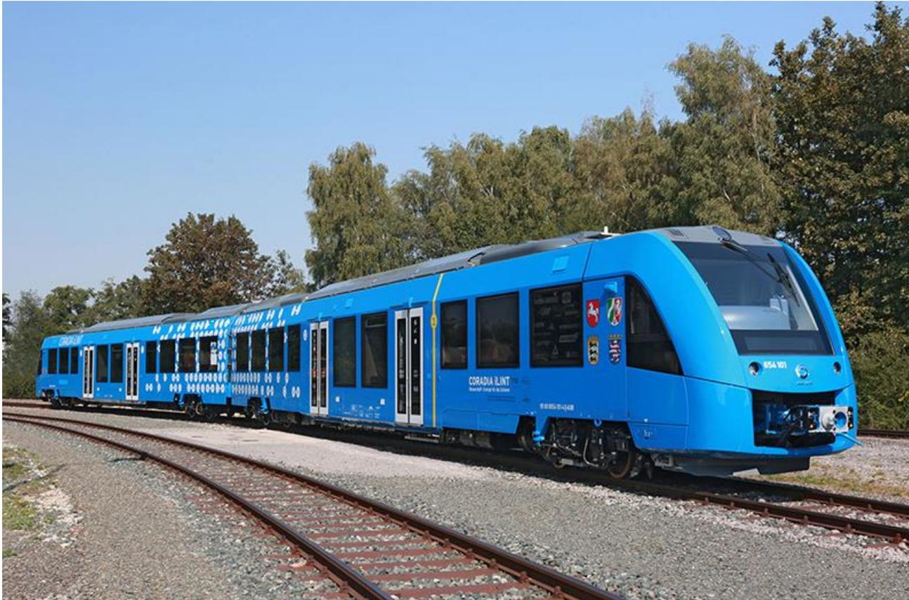
Der Coradia iLint ist der weltweit erste Niederflur-Personenzug, der von einer Wasserstoff-Brennstoffzelle angetrieben wird
